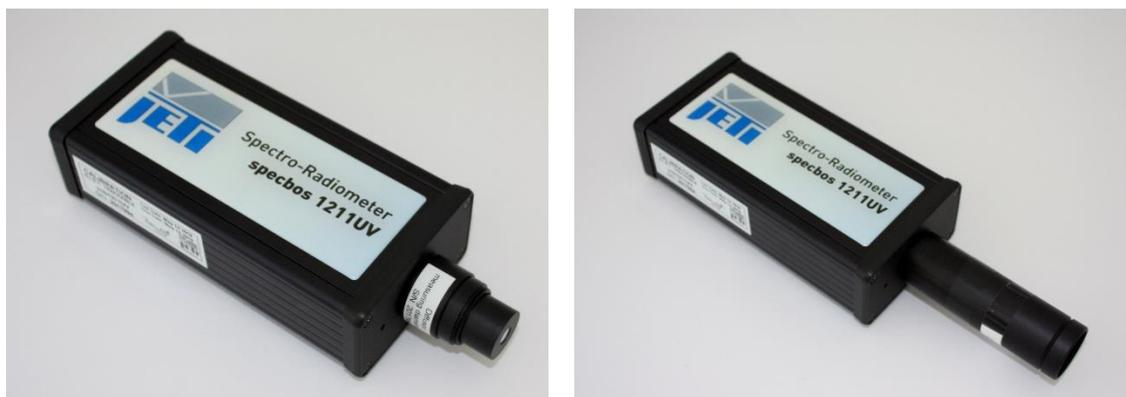
Abb. 8 – Messgerät specbos 1211UV mit den Messvorsätzen für Bestrahlungsstärke (links) und Strahldichte 100 mrad (rechts) [2]
